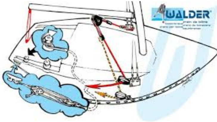
Εικόνα 2 : Εγκατάσταση του φρένου και το φρένο Walder δεξιά
