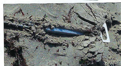
▲ La HB nous a semblé peu encline à se mettre sur le côté. Enfouissement très bon.
