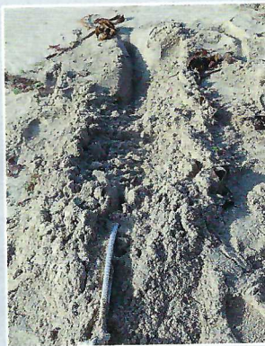
▲ Une fois dans le sable, la Vulcan tend à s'enfoncer à la traction.
