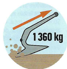
▲ L'enfoncement est immédiat tandis qu'à la traction, la DC creuse doucement un sillon d'une profondeur toutefois relativement modérée.
