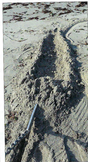
▲ La Rock commence à labourer uniquement sous forte traction.
