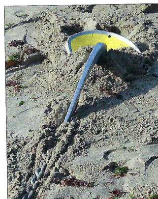
▲ Avec 50 % du poids dans la pointe, la Spade s'enfonce vite.
