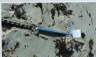
◀ La Brittany s'ensable à vive allure mais résiste mal aux fortes tractions. Ne pas hésiter dans ce cas à mettre plus de chaîne.
