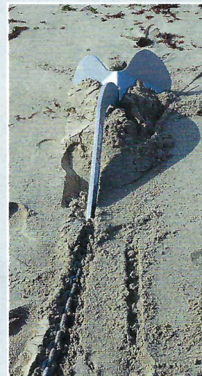
▲ La Kobra s'ensable assez vite à la traction.
