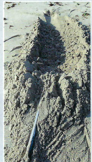
▲ Sous charge, elle chasse en douceur avant de finir par céder.
