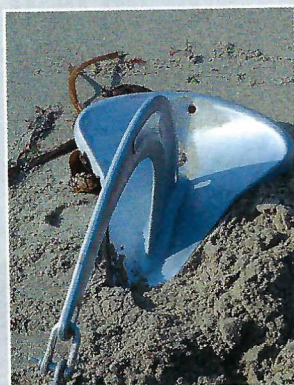
▲ L'accroche, malgré la forme concave de la pelle, est moyenne.
