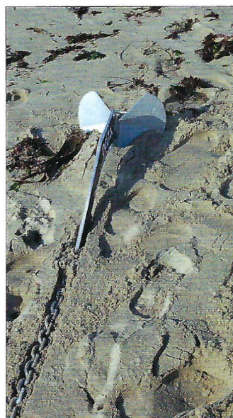
▲ Le comportement de la Delta à l'enfoncement est optimal.
