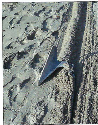
▲ L'articulation de la verge s'ensable : l'ancre traîne sans jamais crocher.
