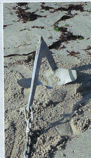
▲ Avec son poids bien réparti sur la pelle, la FHD se pose à plat.
